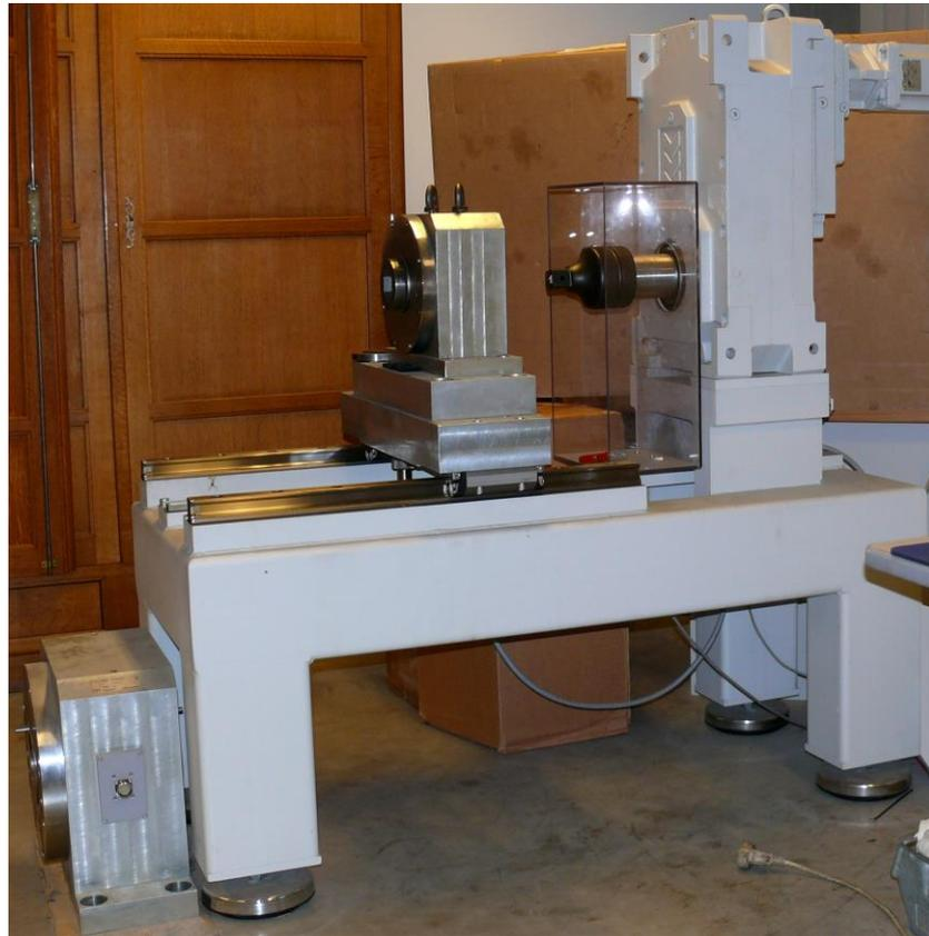
Banc d'essais d'aptitude des boulons, le dispositif permet de déterminer la relation entre le couple de serrage et l'effort dans la vis.
