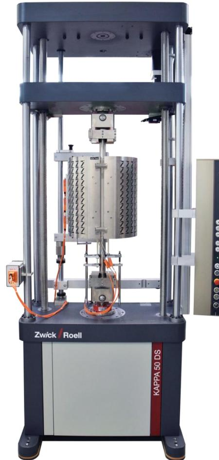
Capacité : Cellule de 100 kN et cellule de 10 kN
