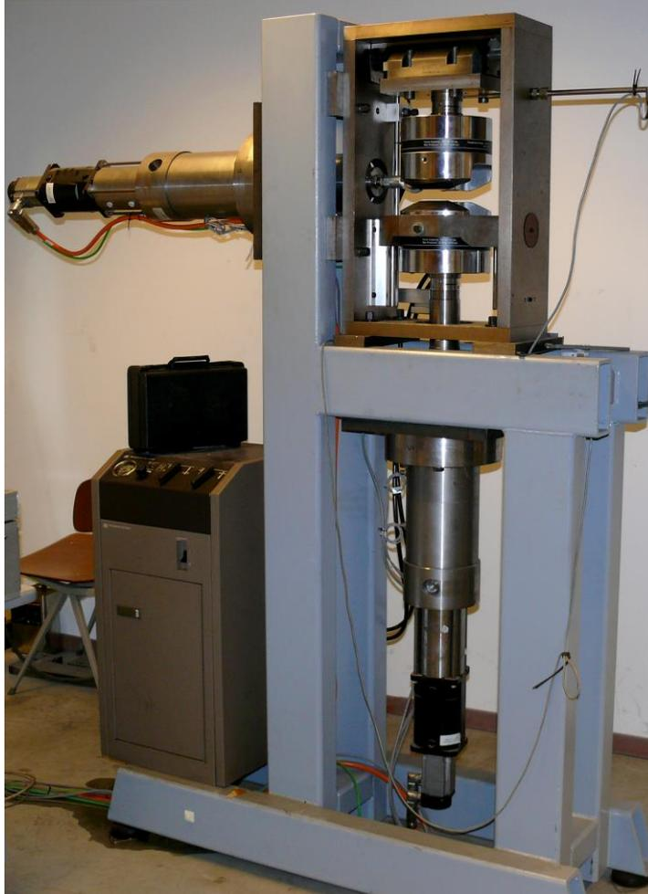
Ce banc d'essais est destiné à la réalisation d'essais de cisaillement sur de tôles jusqu'à 4 mm d'épaisseur.
