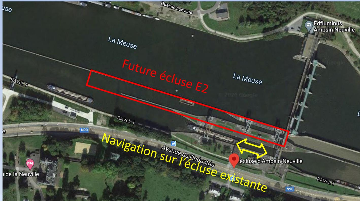
Ecluse existante (E4) maintenue en fonctionnement durant toute la durée des travaux de construction de E2 :
